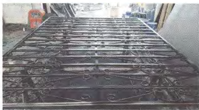
Foto 6: fabricacion instalacion de balcones de hierro en ventana
